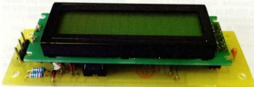
Obr. 4. LCD displej s připojením přes RS232
