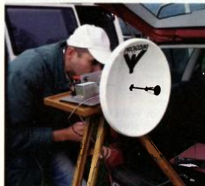
Obr. 3. OK1FPC s novým transvertorem pro pásmo 122 GHz
